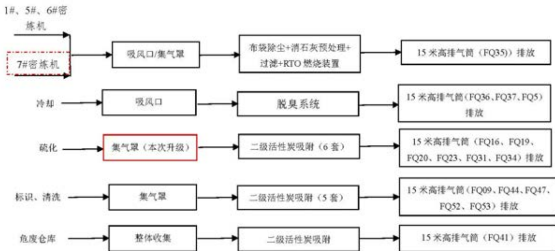
图 6.1-1 技改项目废气收集、处理系统图
